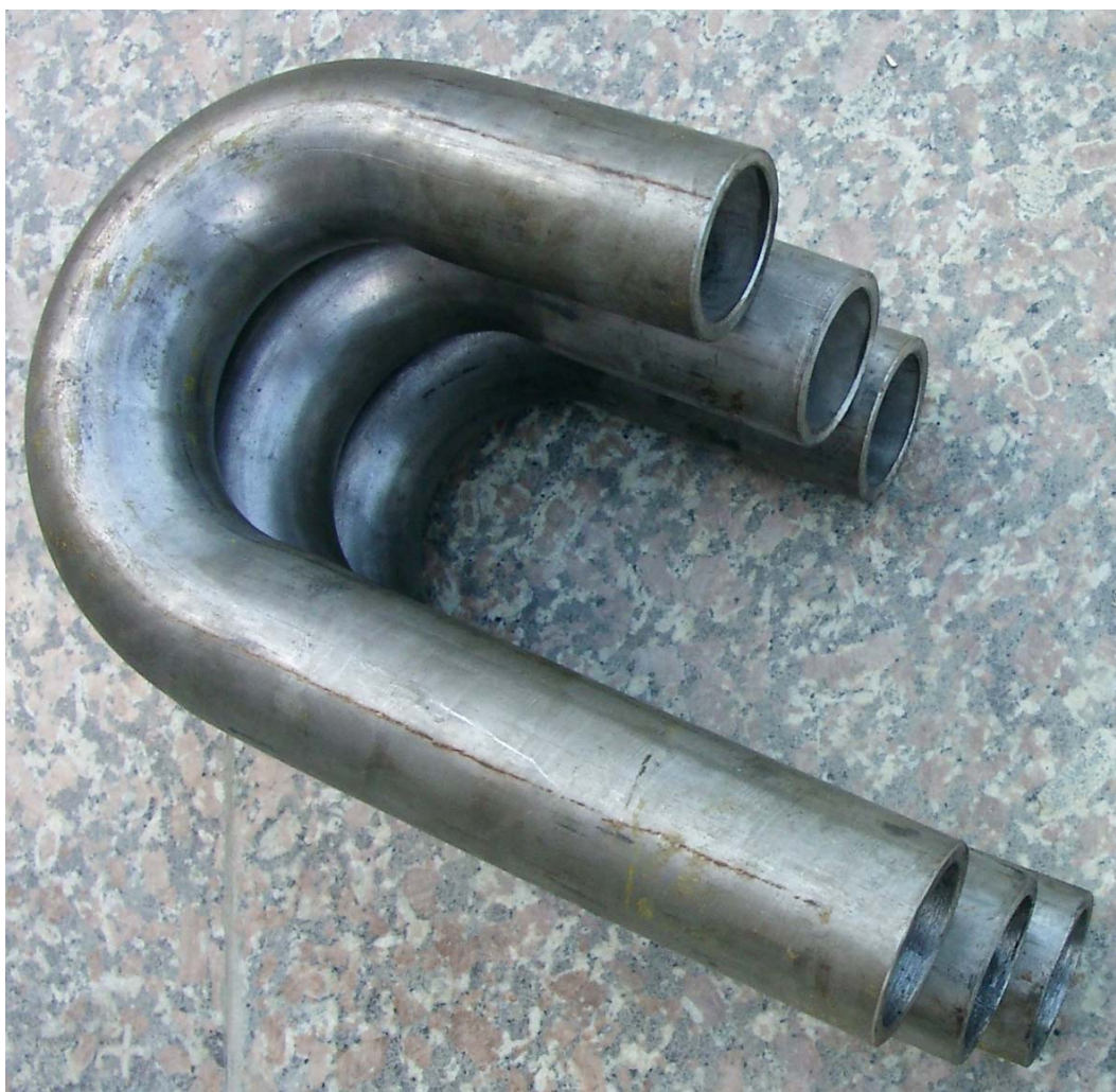
Рис. 2. Фотография изогнутых труб \text{Ø}57 \times 5 из стали 12Х18Н10Т
